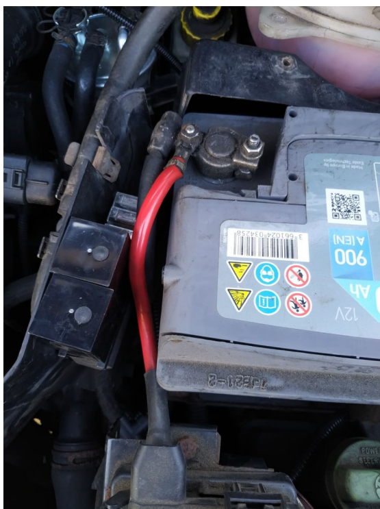
Místo průchodu kabeláže podél brzdového vedení k topení
