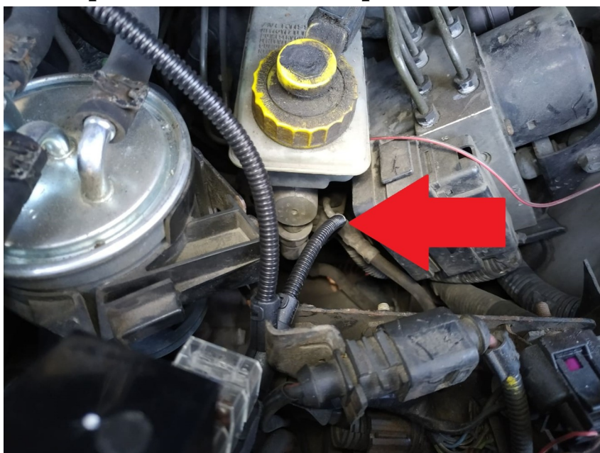
Místo průchodu kabeláže do interiéru
